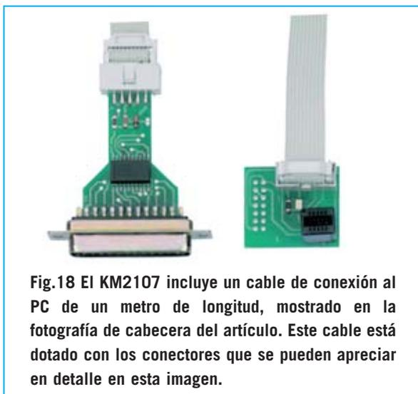
Fig.18 El KM2107 incluye un cable de conexión al PC de un metro de longitud, mostrado en la fotografía de cabecera del artículo. Este cable está dotado con los conectores que se pueden apreciar en detalle en esta imagen.
