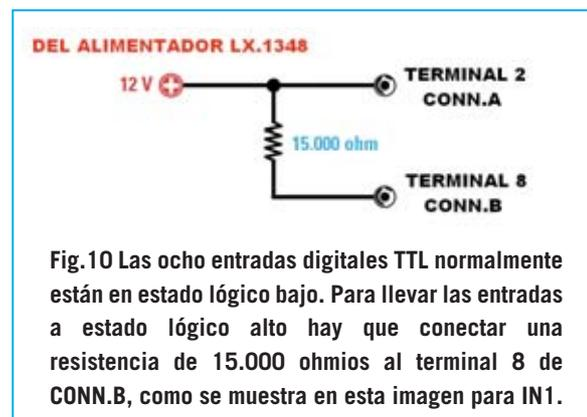
Fig.10 Las ocho entradas digitales TTL normalmente están en estado lógico bajo. Para llevar las entradas a estado lógico alto hay que conectar una resistencia de 15.000 ohmios al terminal 8 de CONN.B, como se muestra en esta imagen para IN1.
