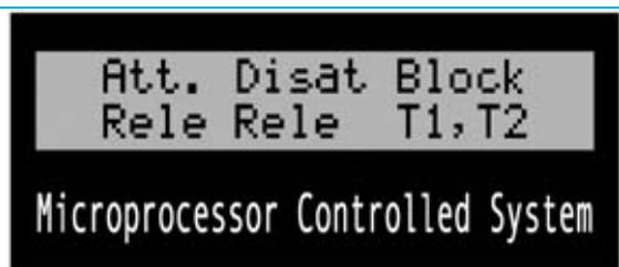
Fig.32 Una vez terminado el proceso de programación el sistema KM2107 inicia la ejecución del programa. En este caso aparece en el display una indicación con las funciones realizadas por las teclas.
