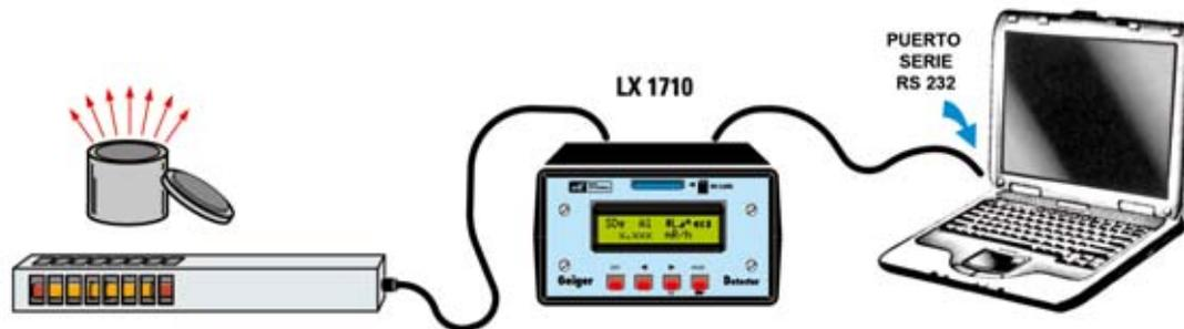
**Fig.1 conectando el contador Geiger al puerto serial del PC podéis seguir en tiempo real el funcionamiento del fenómeno radiactivo. Los datos procedentes del instrumento, actualizados automáticamente cada 10 segundos, se verán en un vídeo y serán memorizados en el disco duro del PC. Para realizar la conexión solo deberéis instalar el programa “Coderad” y seguir las instrucciones.**
