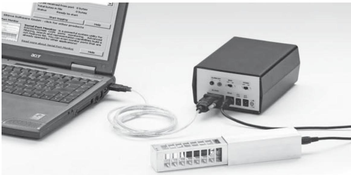
En la foto se puede ver la conexión del contador Geiger al puerto USB del PC utilizando uno de los convertidores RS232/USB disponible en los comercios. Seguid atentamente las instrucciones de instalación del convertidor antes de proceder a la conexión.
