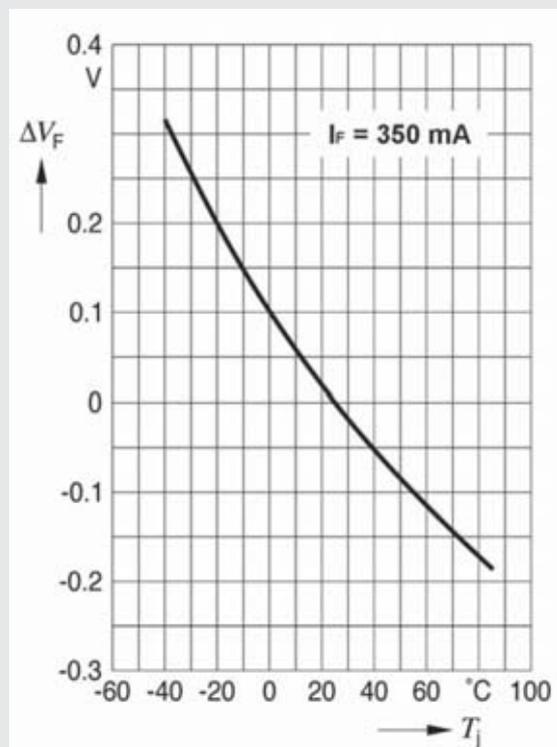
Si medimos la tensión de umbral de un led de potencia, conduciéndolo con una corriente de 350 miliamperios y manteniendo la temperatura de su conexión a 25 °C, conseguimos un valor en voltios, que llamaremos valor  $V_0$ .
