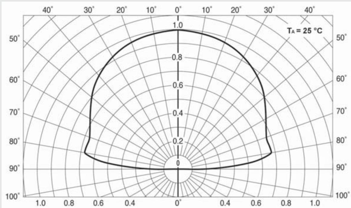
La intensidad luminosa del 100%, correspondiente con la curva 1.0, se observa si miramos el diodo de frente, es decir a 0° respecto a su eje vertical. Mientras nos desplazamos poco a poco hacia un lado, la intensidad de luz disminuye, descendiendo a 0,8, es decir al 80% en la posición que corresponde a un ángulo lateral del 50°. Se mantiene en un valor de unos 0,7, correspondiente al 70% en un ángulo de 80°, para después anularse a 90°.
