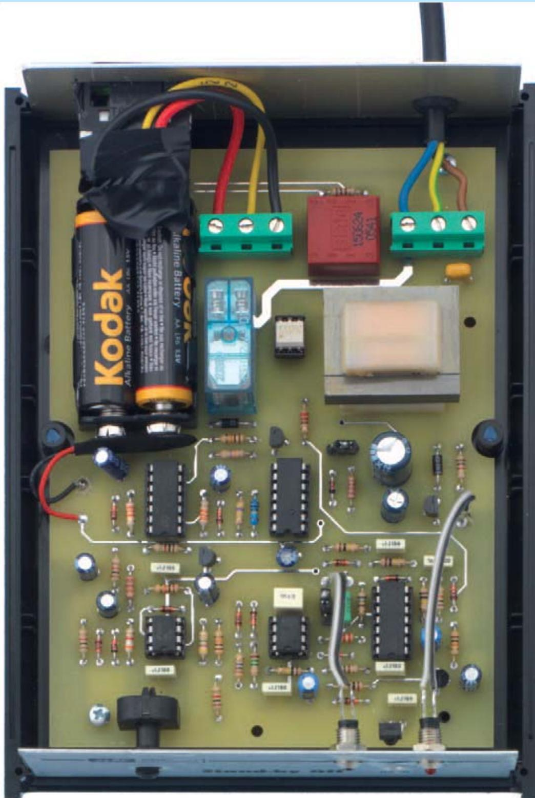
*Fig.8 En esta foto se puede ver el circuito montado, insertado en el chásis. Antes de cerrarlo, debéis realizar las operaciones de cableado de los componentes y su calibración. En este sentido sugerimos leer atentamente los párrafos pertinentes.*
