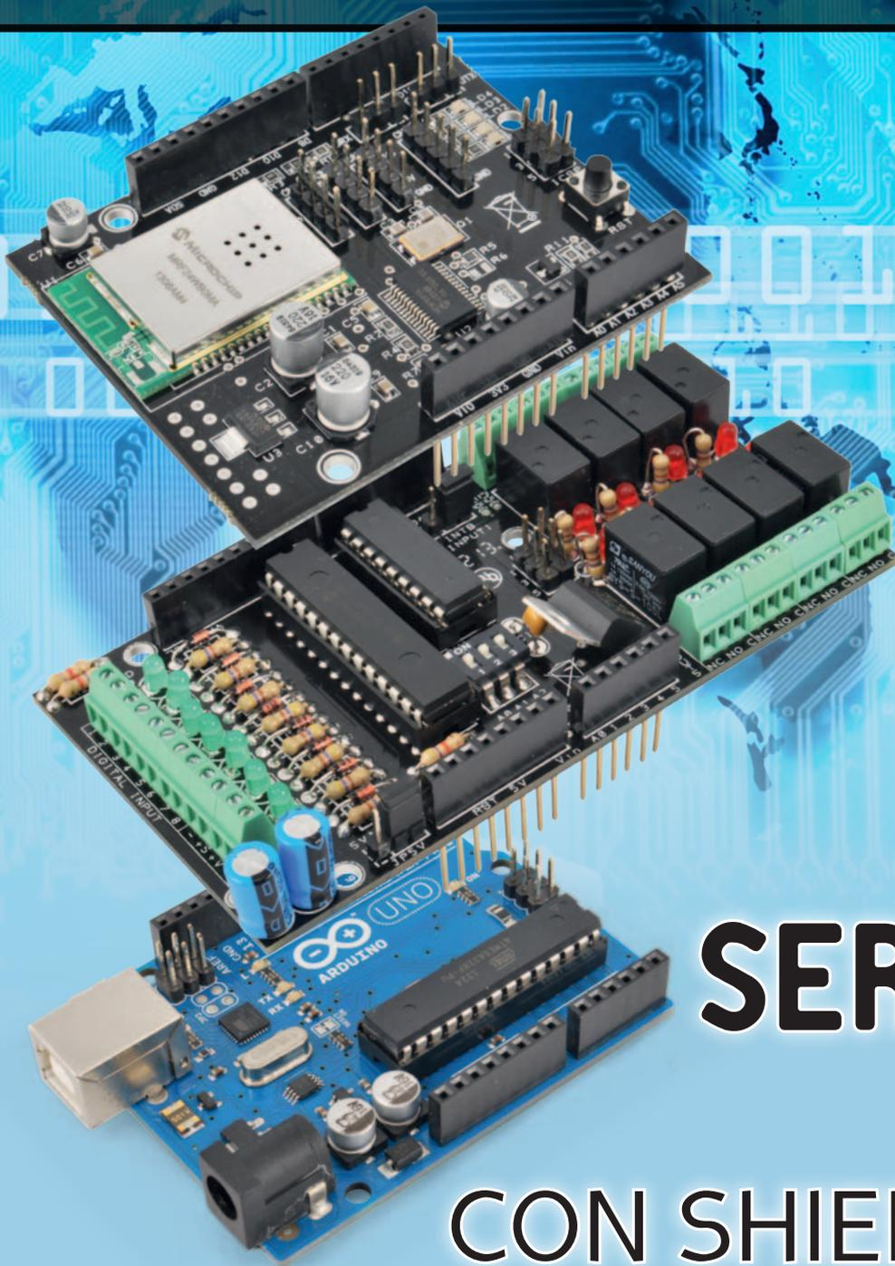
Conectamos nuestro shield WiFi con Arduino y realizamos, con la librería específica HTTPLib, un Servidor Web Servidor que, con la ayuda de un shield de extensión E/S, lea estados lógicos y controle relés desde una página web.
