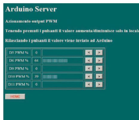
Fig. 7 - Control salidas PWM.
