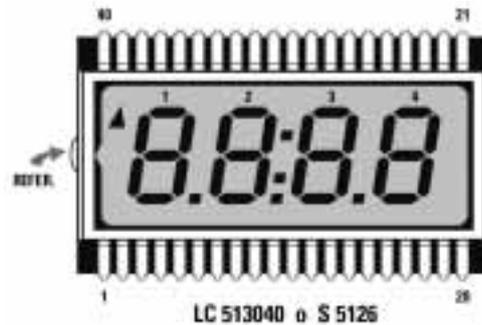
Fig.4 Al instalar el display LCD en los conectores que hacen la función de zócalo hay que controlar que la **pequeñísima** protuberancia de vidrio (ver REFER) quede orientada a la izquierda. También puede aparecer como referencia una señal en forma de < en el marco interior del display (ver Fig.6).
