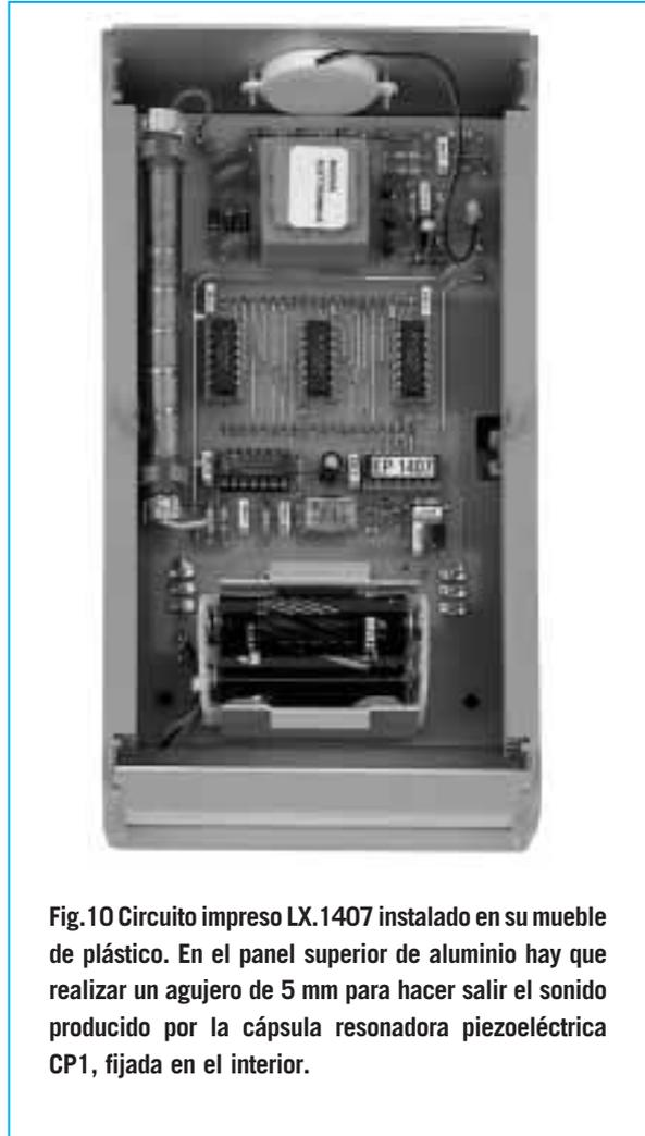
Fig.10 Circuito impreso LX.1407 instalado en su mueble de plástico. En el panel superior de aluminio hay que realizar un agujero de 5 mm para hacer salir el sonido producido por la cápsula resonadora piezoeléctrica CP1, fijada en el interior.
